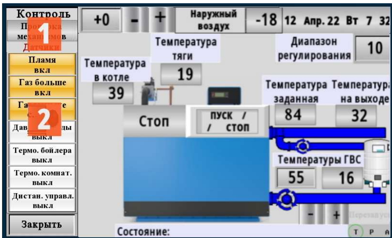
Рис. 19 Проверка состояния датчиков
