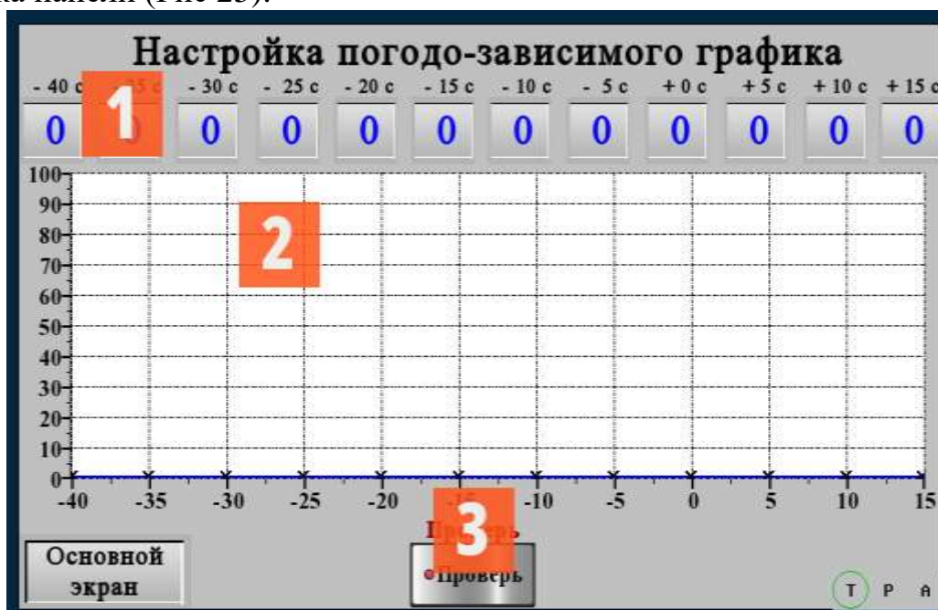
Рис. 15 График зависимости температуры на выходе из котла от температуры наружного воздуха
